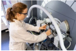
Batterieforschung: Untersuchung der Materialstruktur einer Batterie während des Betriebs mittels Röntgenbeugung (XRD). Foto: JLU / Rolf K. Wegst
