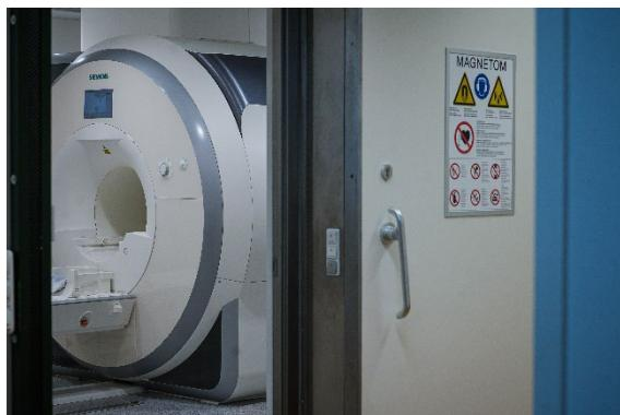
3-Tesla-Magnetresonanztomograph: Das BION stellt die Infrastruktur für den Einsatz der Magnetresonanztomographie (MRT) vor allem für neurowissenschaftliche Forschungsprojekte bereit. – Fotos: JLU / Katrina Friese
